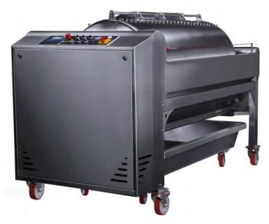
Il software esclusivo, con l'ampio display touch screen, permette di gestire il macchinario velocemente sia impostando uno dei 12 programmi automatici caricati di serie, sia modificando velocemente un qualsiasi programma automatico personalizzandone le attività (rotazioni / pressioni / durata), sia gestendo il macchinario con i comandi manuali (rotazione / compressore / soffianti).
