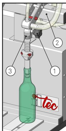
Per variare il livello massimo del liquido nella bottiglia modificare la posizione del collare "4" dopo aver allentato le brugole "5" (vedi fig. 8). Se il collare non risultasse ben adeso al beccuccio usare la chiave esagonale in dotazione per stringerlo.
